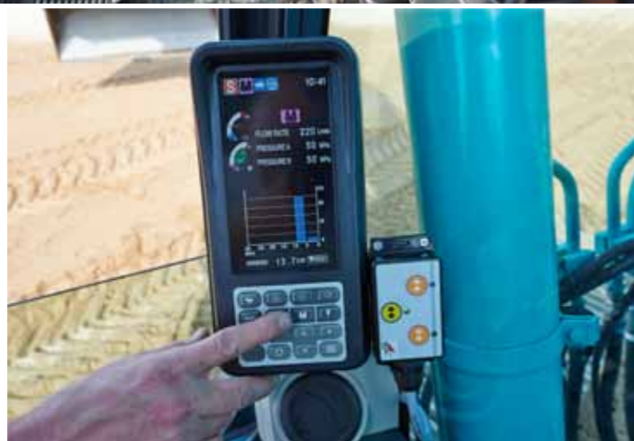
Links: Das Display-Layout kann individuell eingestellt werden. Es ist beispielsweise möglich, dass alle 5 Minuten der Verbrauch angezeigt wird.
